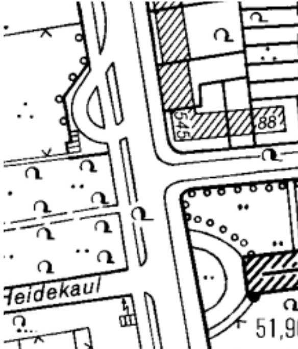
s) In diesem Beispiel existiert ein Platz mit einer Hauptfahrbahn auf der Westseite und einer Parallelfahrbahn auf der Ostseite zur Erschließung der Wohnbebauung.
