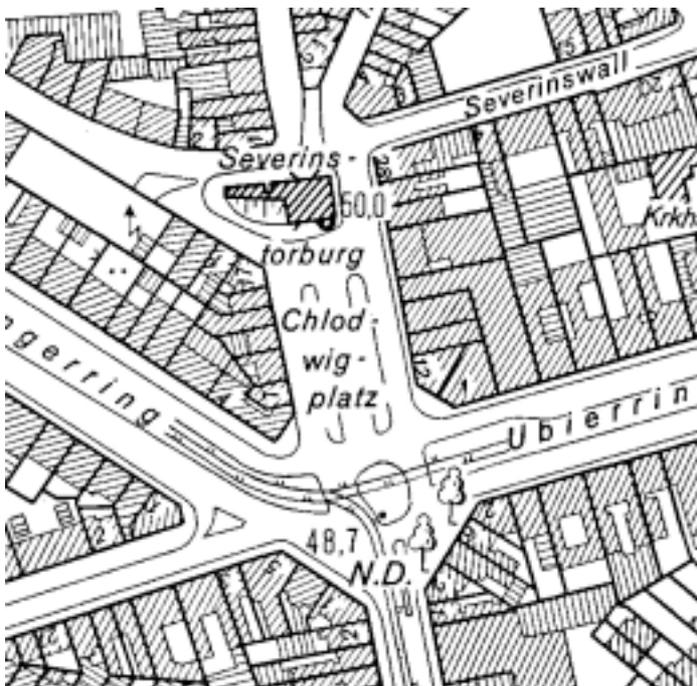
n) Dieses Beispiel zeigt den Fall, dass der schienengebundene ÖPNV den Straßenverlauf verlässt (bis dahin Mittellage) und in einer eigenen Trasse weiter verläuft.
