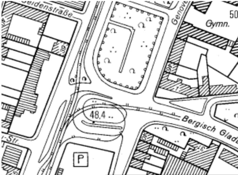
m) Dieses Beispiel zeigt eine Platzsituation, bei der zwei Platzbereiche aneinander grenzen. Der untere Bereich ist als Kreisverkehr mit Führung des schienengebundenen ÖPNV ausgebildet. Der obere Bereich ist im zentralen Bereich nur für Busse geöffnet. Der MIV darf nur am linken Rand von Süden nach Norden den Platz befahren.
