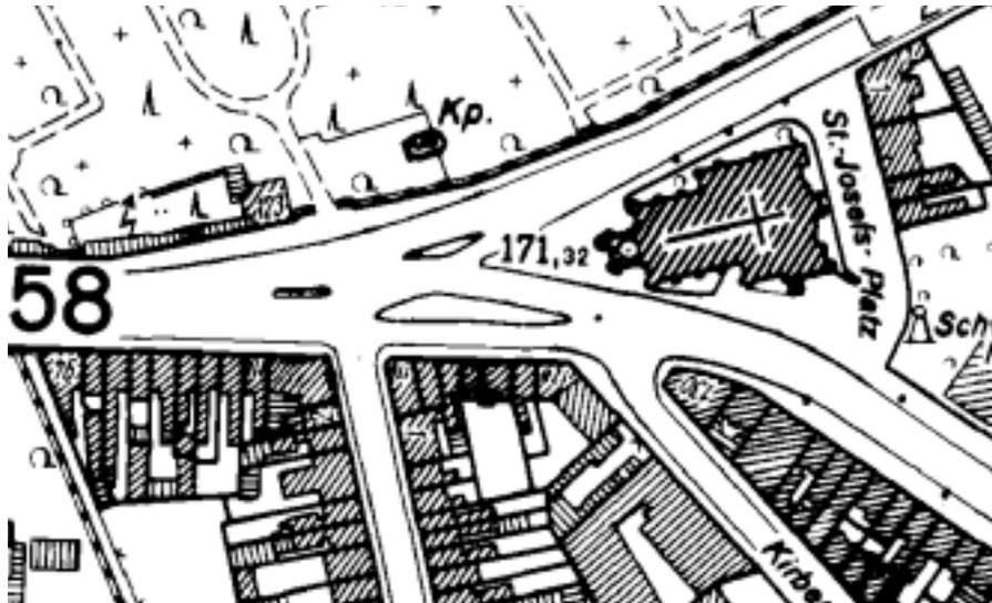
d) Dieses Beispiel zeigt eine Situation mit kompliziertem Knotenpunkt. Da eine der Hauptstraßen als Allee ausgebildet ist, kommt es zu einer komplexen Führung der Verkehrswege für den Radverkehr und die Fußgänger. In diesem Beispiel existiert weiterhin eine Haltestelle an einer in der Mitte der Straße verlaufenden Busspur in unmittelbarer Nähe südlich vom Knotenpunkt.
