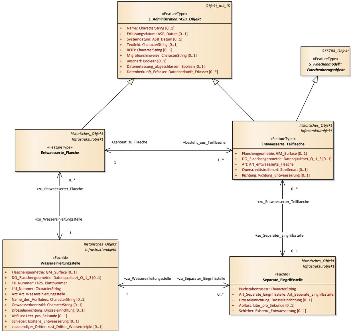
Diagramm: Entwässerte Fläche
